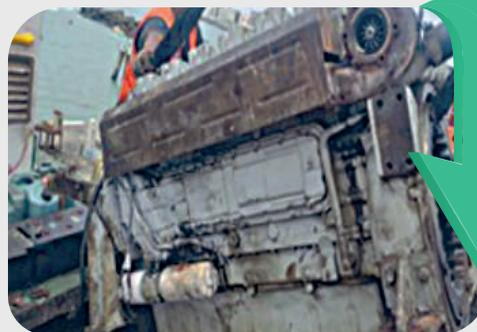
Retiro de las máquinas principales y cajas de reducción de la lancha Helios
