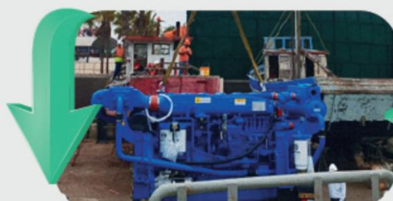
Izado de máquina nueva para montaje en la sala de máquinas.
