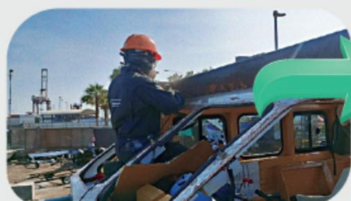
Trabajos de remplazo del techo de la lancha - zona no tratada durante la construcción.
