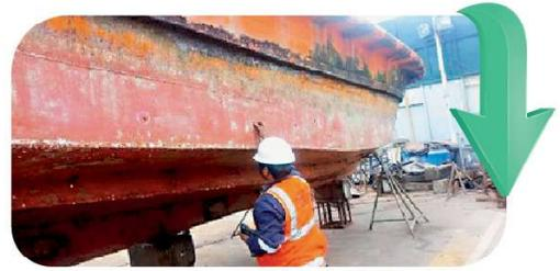
Se identificó una zona en el centro hacia popa de ambas bandas con espesor límite, por lo que debe programarse el reemplazo de estas planchas en el próximo recorrido.
