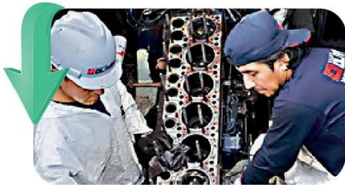
Se realizó mantenimiento de 6000 horas a la máquina principal y se reguló la bomba para llegar a 1800 rpm y alcanzar velocidades superiores a los 9 nudos.
